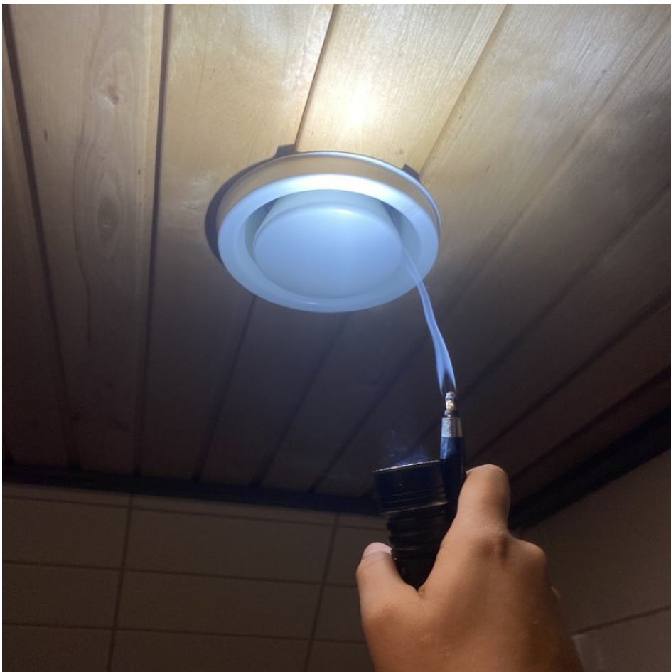
4. Yleiskuva: Ilmanvaihtojärjestelmän poistokanavien ilmavirtausta testattiin merkkisavulla pistokoeluontoisesti. Ilmavirtaussuunnissa ei havaittu puutteita. Testi suoritettiin pesuhuoneessa ja saunassa.
